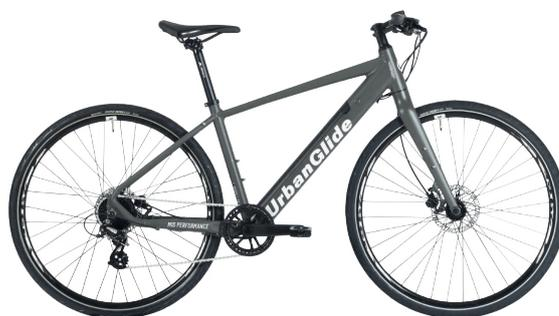
Le vélo électrique M1S sera votre allié de tous les jours. Équipé d'un moteur arrière de 250W, et d'un dérailleur 8 vitesses Shimano, vous pourrez atteindre facilement les 25km/h. Grâce à sa batterie amovible 9,6Ah, vous pourrez parcourir jusqu'à 60km en une seule charge.
