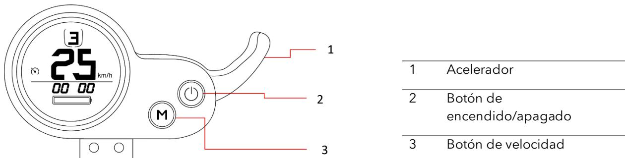
**Botón de encendido/apagado** : Pulse una vez para encenderlo, pulse de nuevo para apagarlo.
