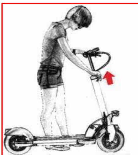
Ajuste el tamaño de su manillar aflojando la abrazadera de la potencia. Tenga cuidado de no sobrepasar el límite de altura indicado. Comprueba que tu manillar esté estable y que la abrazadera está bien ajustada.
