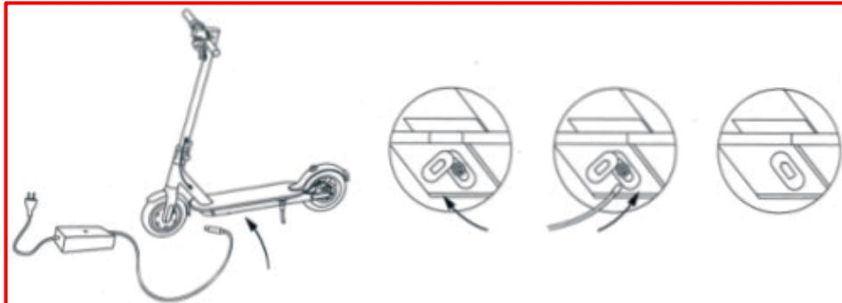
Cuando cargue su patinete, asegúrese de que el puerto de carga está en buen estado y que no hay residuos atascados en él. Si es así, límpialo con un paño seco. Utilice el cargador suministrado con el producto, y sólo ese cargador. Si has perdido tu cargador o está defectuoso, ponte en contacto con el servicio de asistencia de Urbanglide. Una vez que el cargador muestre una luz verde, desenchufe su producto. No deje el cargador enchufado durante mucho tiempo después de la carga.
