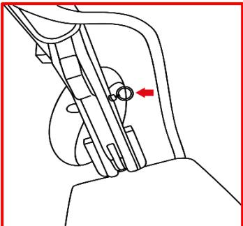
Pour pouvoir tirer sur la poignée de pliage, il faut ôter la sécurité en tirant sur la boucle située à droite.
