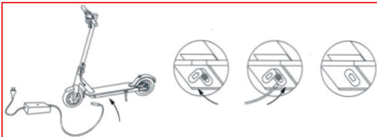
Cuando cargue su scooter, asegúrese de que el puerto de carga está en buen estado y que no hay residuos atascados en él. Si es así, límpialo con un paño seco. Utilice el cargador suministrado con el producto, y sólo ese cargador. Si has perdido tu cargador o está defectuoso, ponte en contacto con el servicio de asistencia de Urbanglide. Una vez que el cargador muestre una luz verde, desenchufe su producto. No deje el cargador enchufado durante mucho tiempo después de la carga..
