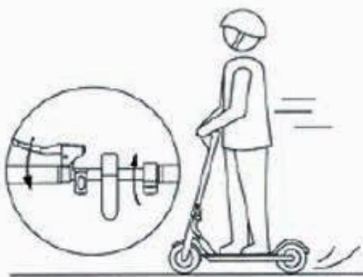
Para frenar, apriete suavemente las palancas de freno del manillar.
