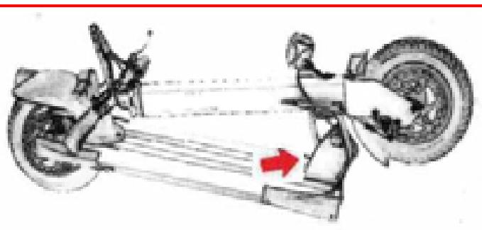
A continuación, tire del asa de plegado para desplegar su scooter. Endereza la potencia y levanta el manillar hacia arriba. Una vez que se haya enderezado al máximo, vuelva a colocar el asa de plegado en su posición original.
