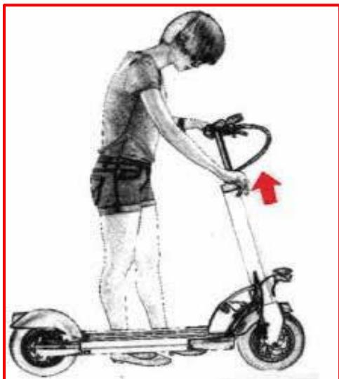
Ajuste o tamanho do seu guiador desapertando a pinça no tronco. Ter o cuidado de não exceder o limite de altura indicado. Verifique se o seu guiador está estável e se a braçadeira está apertada.
