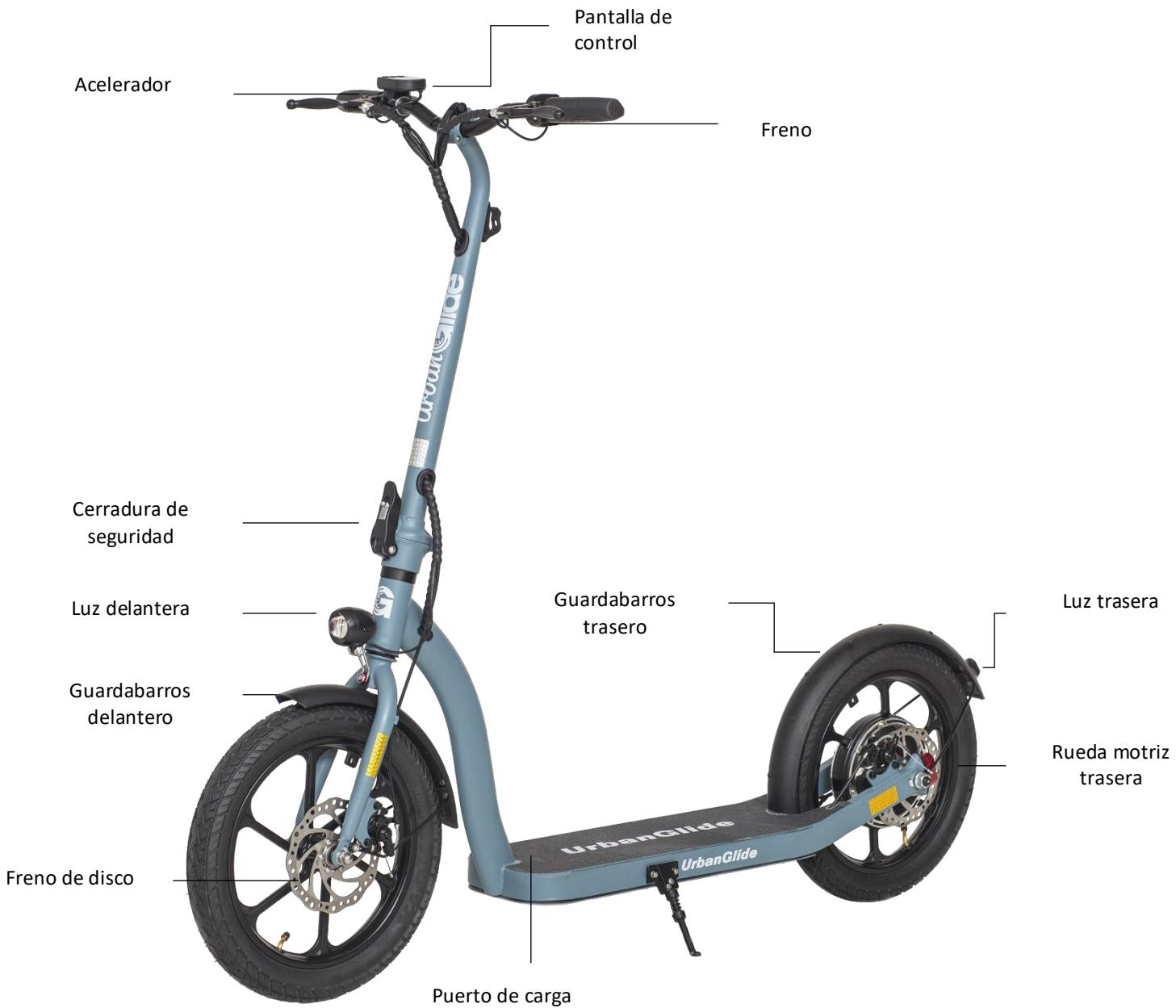
Para avanzar, encienda el scooter presionando el botón , comience con la velocidad 1 para aprehender la velocidad, para cambiar de marcha presione el botón , coloque uno de los dos pies en la bandeja, dé un impulso con el pie y use el gatillo derecho en su manillar para mover su scooter hacia adelante. Para encender la luz, presione la flecha hacia arriba
