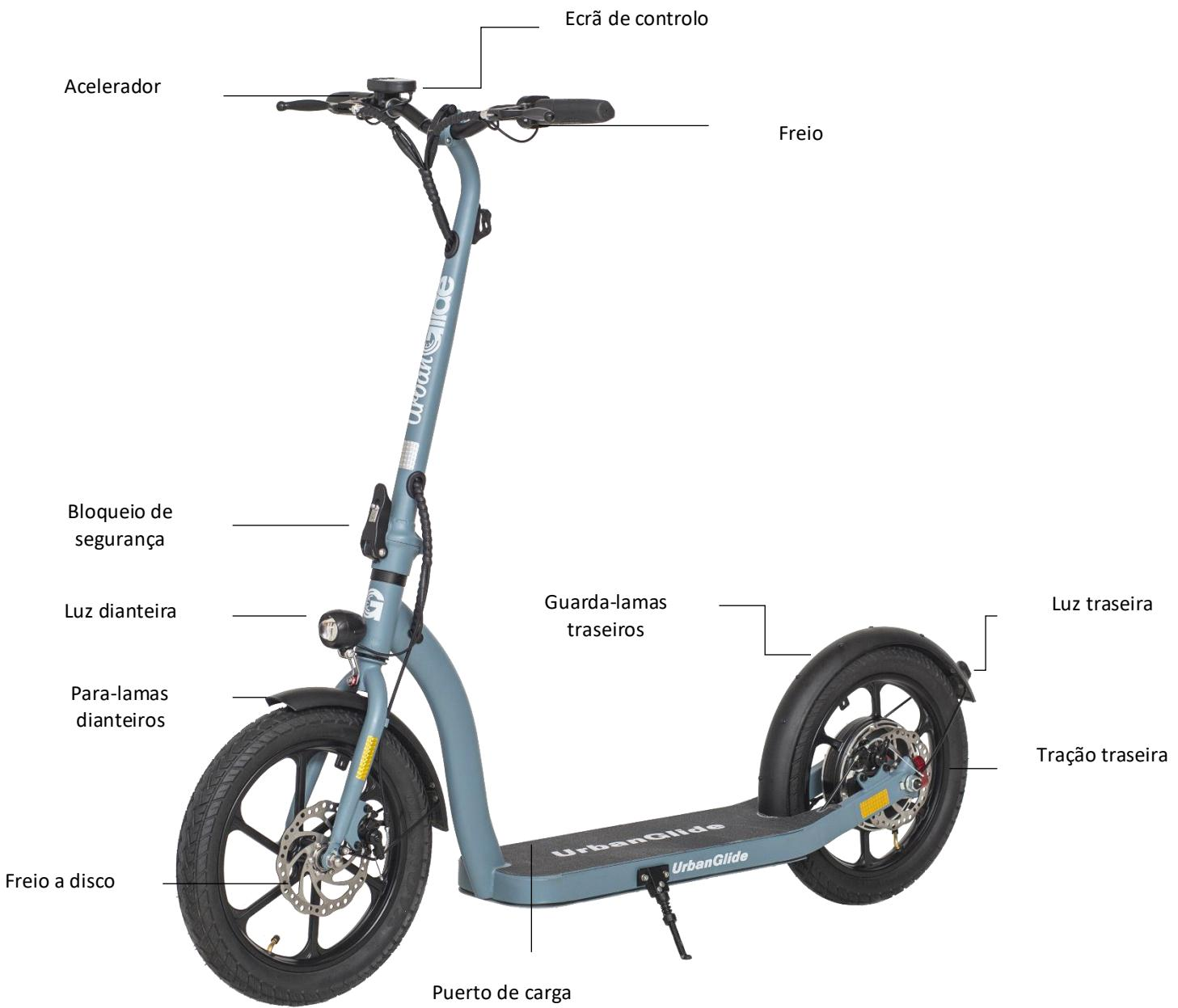
Para avançar, ligue a scooter pressionando o botão , comece com a velocidade 1 para apreender a velocidade, para mudar de marcha pressione o botão , coloque um dos dois pés na bandeja, dê um impulso com o pé e use o gatilho direito no guidão para mover sua scooter para a frente. Para acender a luz, pressione a seta para cima .
