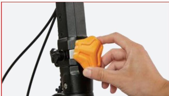
Desserrez la boucle de pliage.
