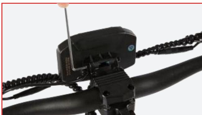
Ajustez l'écran à un angle approprié, puis serrez les vis à l'arrière.
