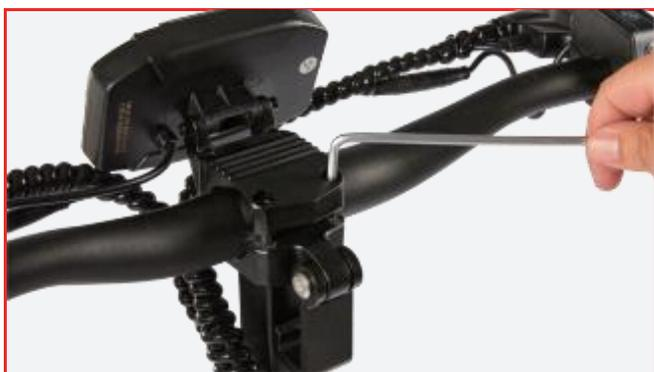
Après avoir positionné correctement le guidon, serrez les 4 vis du cache de la potence.
