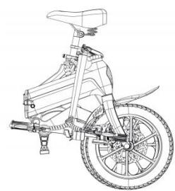
Déverrouillez le levier situé au milieu du cadre et plié celui-ci. La batterie amovible se trouve à l'intérieur, déverrouiller à l'aide de la clé.
