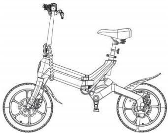
Abra a alavanca de liberação rápida do guidão e ajuste o guidão.
