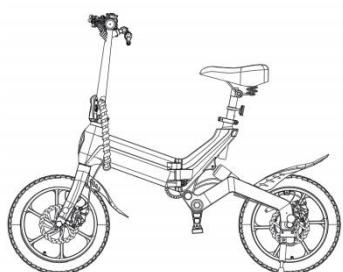
Abra la palanca de liberación rápida del manillar y ajuste el manillar.
