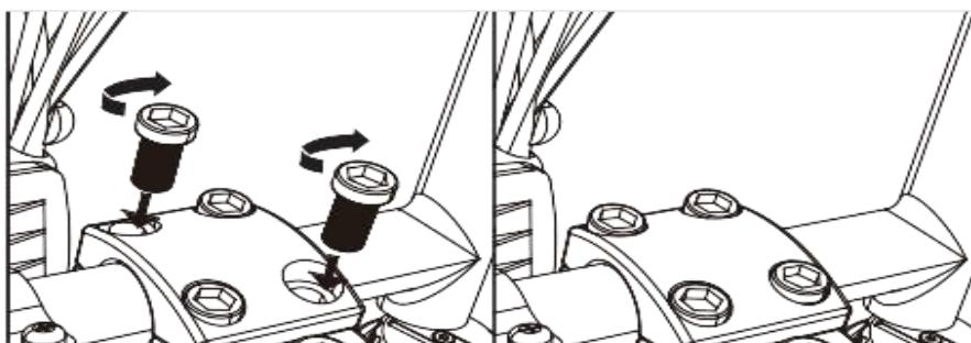
Posicione corretamente o guidão ajustando a regulagem, use uma chave M6 e aperte os parafusos no sentido horário.
