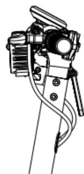
3. Insira o conector e coloque a barra em T no tubo vertical, em seguida, aperte os parafusos de ambos os lados.
