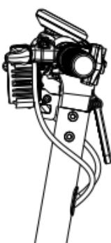
3. Insérez le connecteur, puis insérez la barre en T dans le tube vertical, ensuite serrez les vis des deux côtés.
